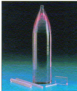
Fig. 5.5. Nd:YAG boule (VLOC, 2002).
