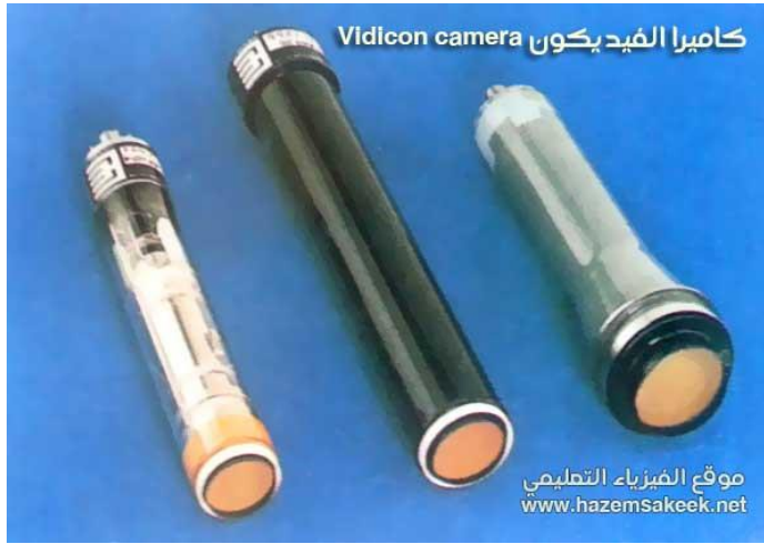
الشكل 6 كاميرا الفيديكون Vidicon camera
