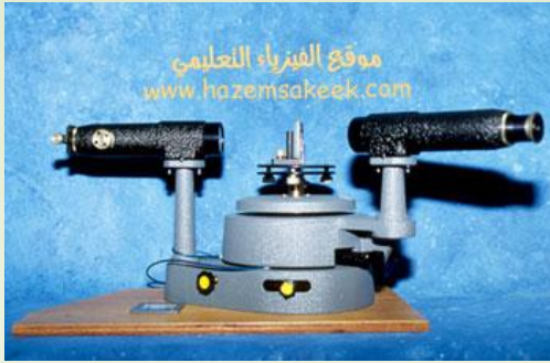
مطياف بسيط يستخدم منشور لتشتيت الضوء والتلسكوب مثبت على قاعد تدور حول المنشور
