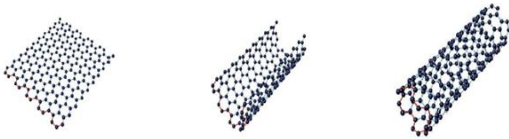
شكل (3) : التفاف صفيحة الجرافين لتشكيل الأنبوب النانوي
