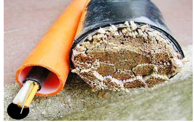
شكل (5) الفرق بين كابل النحاس وكابل الألياف البصرية من حيث الحجم
