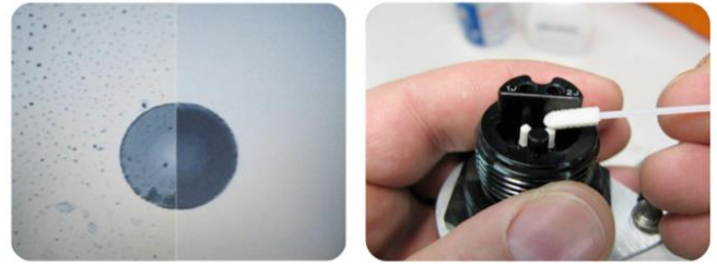
شكل (14) تنظيف وصلات الاليف البصرية باستخدام العيدان القطنية المبللة بالكحول
