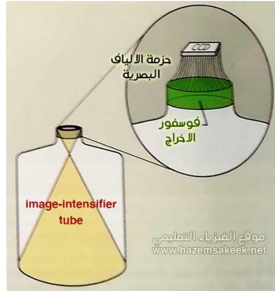
الشكل 10 طريقة ربط الصورة المتكونة على طبقة فوسفور الإخراج في انبوبة زيادة شدة الإضاءة مع شريحة CCD من خلال حزمة الاليف البصرية.
