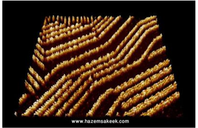
صورة STM لسلسلة جزئيات تجمعت بشكل ذاتي لشبه موصل عضوي على الجرافيت
